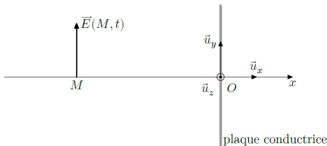
**Figure 1** Onde électromagnétique rencontrant un conducteur parfait
