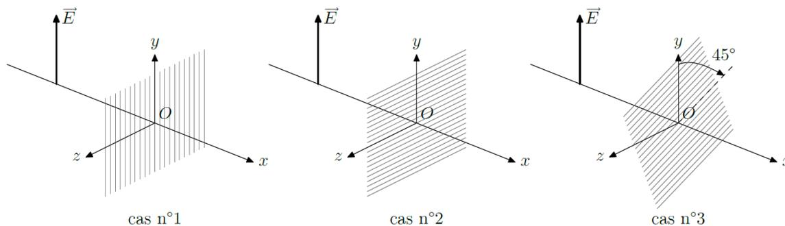
**Figure 5** Onde électromagnétique incidente sur une grille métallique
