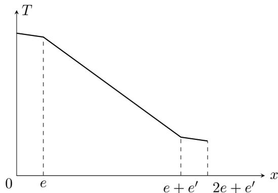
On remarque que c'est l'air entre les deux vitres qui "encaisse" la plus forte diminution de température.
