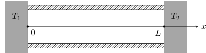
FIGURE 1 – Les températures de la barre sont imposées aux deux extrémités grâce à deux thermostats.
