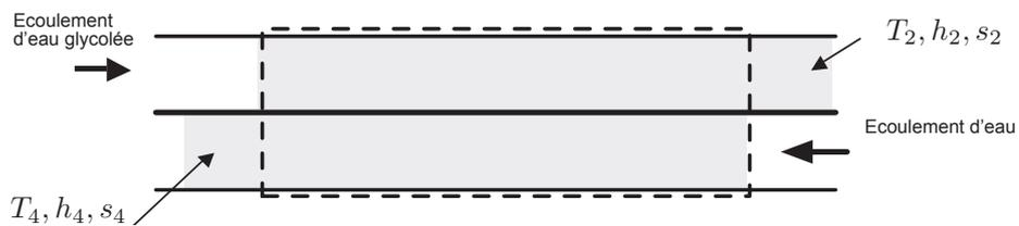
FIGURE 8 – Echangeur à l'instant final.
