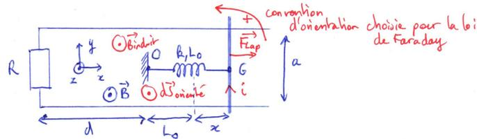
A l'instant initial, on lâche la barre de puis  $x_0 > 0$ , et le ressort est donc étiré de sorte que la tige va se déplacer vers la gauche sous l'effet de la force de tension du ressort  $\vec{F}_r$ .
