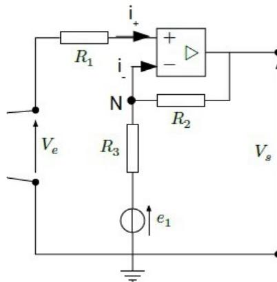
Comme  $i_+ = 0$  la tension aux bornes de la résistance  $R_1$  est nulle et donc  $v_+ = V_e$ . Appliquons une loi des nœuds à l'aide des potentiels (LDNV) en  $N$  :
