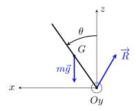
L'arbre est un solide en rotation autour de l'axe fixe Oy, avec un vecteur rotation  $\overrightarrow{\omega} = \dot{\theta} \overrightarrow{e_y}$ . Il est soumis à deux forces :
