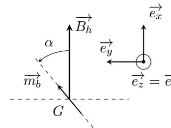
L'équilibre de la boussole correspond au cas où le moment magnétique est aligné avec le champ magnétique. Dans le cas d'une boussole avec un axe de rotation vertical, il faut que celle-ci soit alignée avec la composante horizontale  $\vec{B}_h$ .
