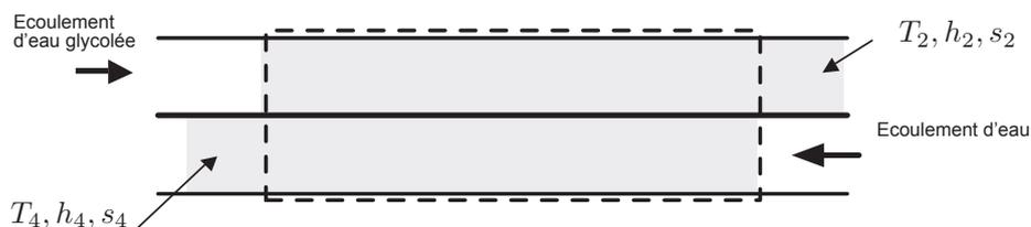
FIGURE 8 – Echangeur à l'instant final.
