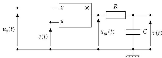
La fonction de transfert du filtre est  $\underline{H}(j\omega) = \frac{v}{u_m} = \frac{1}{1+RCj\omega}$
