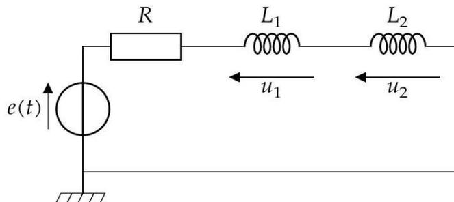
Le montage a une structure de pont diviseur de tension :
