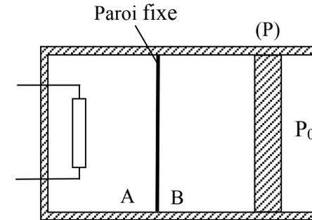
La face externe du piston est en contact avec l'atmosphère dont la pression est constante et vaut  $P_0 = 1,00 \text{ bar}$ . Le cylindre et le piston sont des isolants thermiques parfaits.
