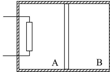
l'état initial ( $E_0$ ) les deux compartiments sont à la même température  $T_0 = 298$  K et sous la même pression  $P_0 = 1,00$  bar.
