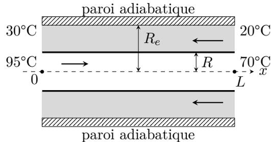
À nouveau les températures des deux fluides sont supposées ne dépendre que de  $x$ . On note respectivement  $T_C(x)$  et  $T_F(x)$  les températures du fluide chaud et froid à l'abscisse  $x$  et on pose  $\Delta T(x) = T_C(x) - T_F(x)$ .
