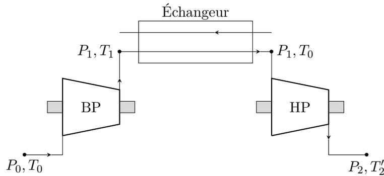
La température  $T_2$  est relativement élevée, et peut risquer d'endommager certains éléments du compresseur. Pour contourner cette difficulté, on préfère utiliser deux compresseurs qui permettent d'atteindre le même rapport de compression mais avec une température finale plus faible ; on parle de compression à deux étages.
