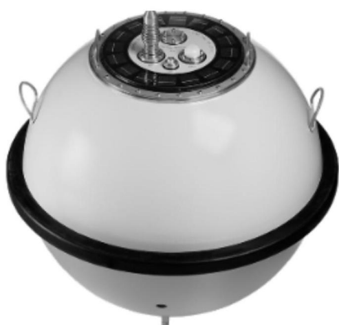
FIGURE 1 – Photographies d'une bouée houlographe Waverider
