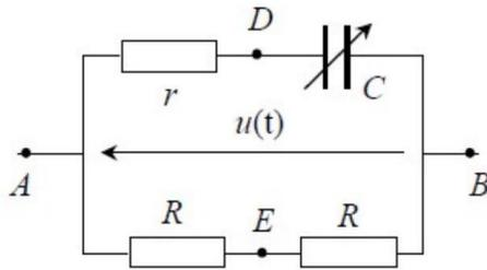
Une tension sinusoïdale  $u(t) = U_m \cos(\omega t)$  est appliquée entre les points A et B du circuit représenté ci-dessus. Montrer que l'amplitude de la tension entre les points D et E est indépendante de la capacité C du condensateur. Calculer le déphasage de cette tension par rapport à  $u(t)$ .
