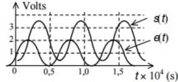
Le signal d'entrée est  $e(t) = E_0 + E_1 \sin(\omega t)$  avec  $E_0 = E_1 = 1$  V. La réponse  $s(t)$  est observée à l'oscilloscope. Déterminer  $G$ . Après avoir étudié le déphasage produit par le filtre, déterminer  $\xi$  et  $\omega_0$ .
