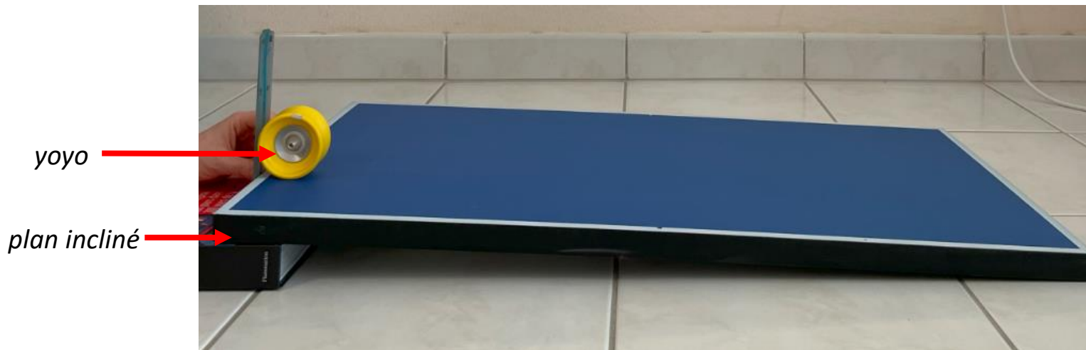
Expérience du plan incliné pour déterminer le moment d'inertie
