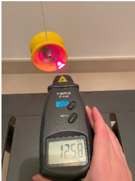
Mesure de la vitesse de rotation avec un tachymètre
