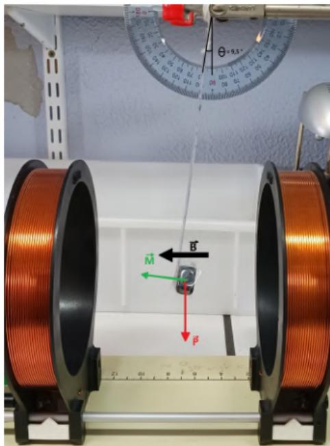
Position de l'aimant une fois que le courant passe dans les bobines, avec les forces exercées sur l'aimant.
