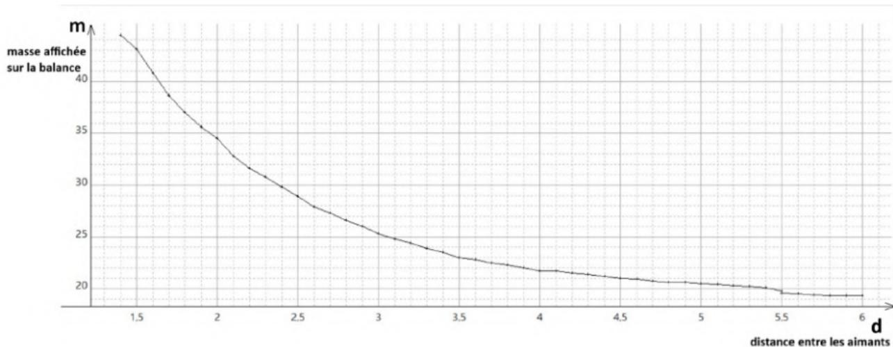
Graph modélisant la masse de l'aimant 2 affichée sur la balance par rapport à sa distance avec l'aimant 1.
