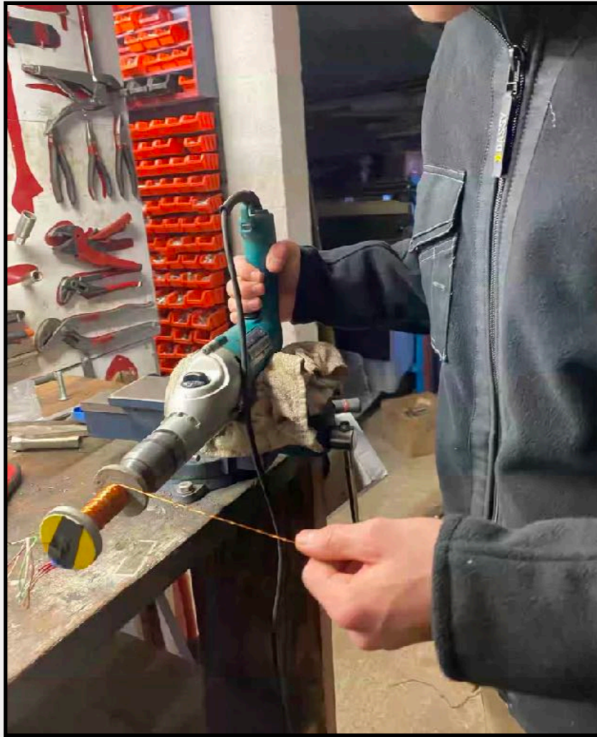
Construction de la bobine
