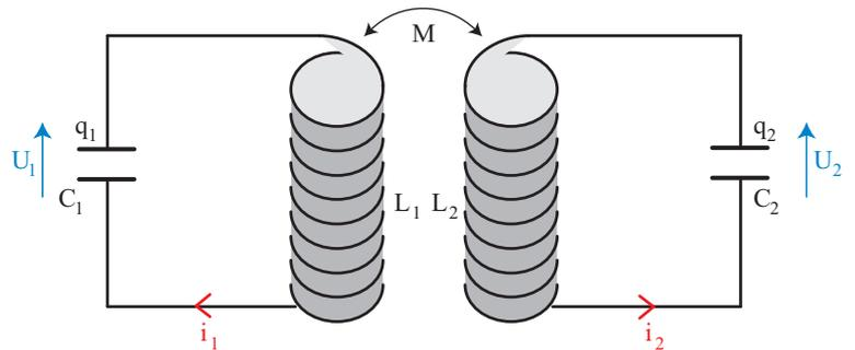
1. Soient  $q_1$  et  $q_2$  les charges des condensateurs à l'instant  $t$ . En se basant sur la position initiale de la charge de chaque condensateur sur le schéma, expliquer pourquoi on a ici  $i_1 = -C \frac{dU_1}{dt}$  et  $i_2 = -C \frac{dU_2}{dt}$ . En déduire un système différentiel en  $q_1$  et  $q_2$ . On posera :
