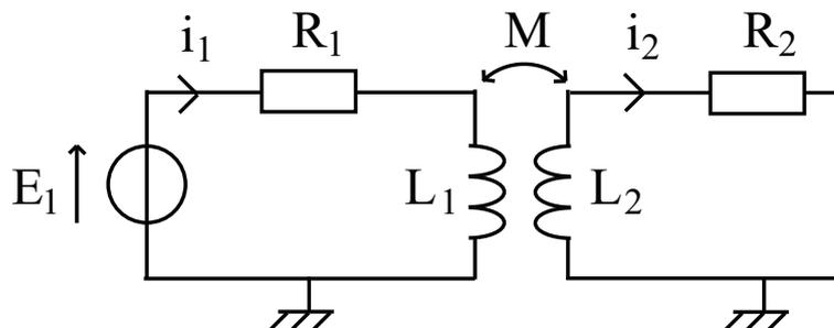
Déterminer le système de deux équations couplant les courants  $i_1$  et  $i_2$  parcourant respectivement les circuits primaire et secondaire.
