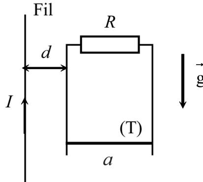
L'ensemble du dispositif est plongé dans le champ magnétique créé par un fil infini parallèle aux rails, parcouru par un courant d'intensité constante  $I$  et situé à une distance  $d$  du rail de gauche. On désigne par  $(Oz)$  l'axe vertical descendant et par  $\vec{g} = g\vec{u}_z$  le champ de pesanteur.
