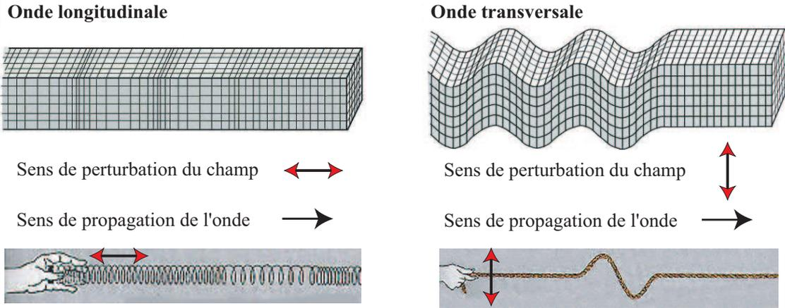
*Expérience* : Mise en évidence des ondes transverses et longitudinales sur un ressort et des ondes longitudinales avec une corde. On notera que la vitesse à laquelle se propage l'onde ne correspond absolument pas à la vitesse des particules constituant le ressort ou la corde<sup>2</sup>.
