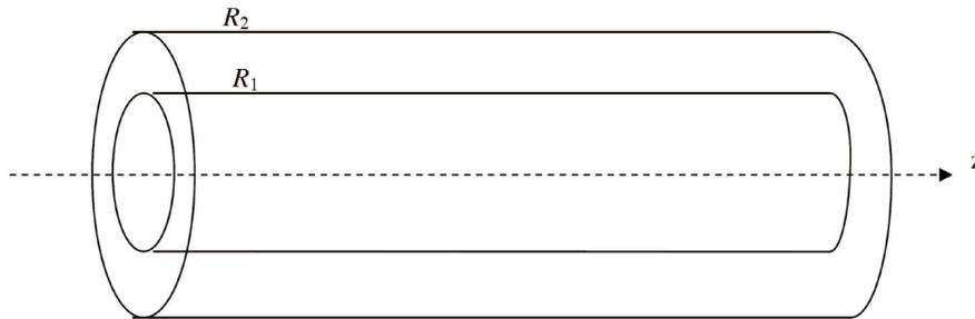
Une onde électromagnétique se propage à l'intérieur du câble dans la région  $R_1 < r < R_2$ , assimilable à du vide. Son champ électrique est donné par :
