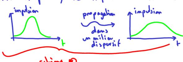
On notera que l'amplitude maximale diminue, mais que la largeur également ( $\neq$  absorption). respecté sur le schéma ou expliqué (\*)
