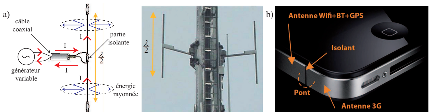
FIGURE 1 – a) Principe de fonctionnement d'une antenne demi-onde et photo d'une antenne émettrice FM ( \lambda/2 = c/2f = 3.10^8/2.100.10^6 = 1.5m ). b) Le pourtour métallique de certains téléphones tient directement lieu d'antenne ( \lambda/2 = c/2f = 3.10^8/2.10^9 = 15cm ).
