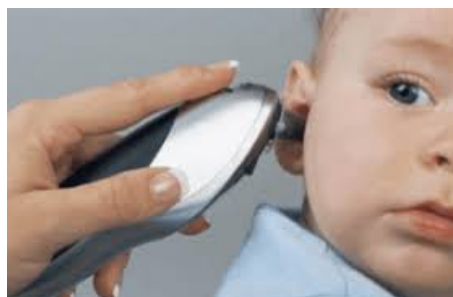
FIGURE 3 – Mesure de la température corporelle basée sur l'émission de rayonnement infrarouge au niveau de l'oreille, à l'aide d'un thermomètre auriculaire.
