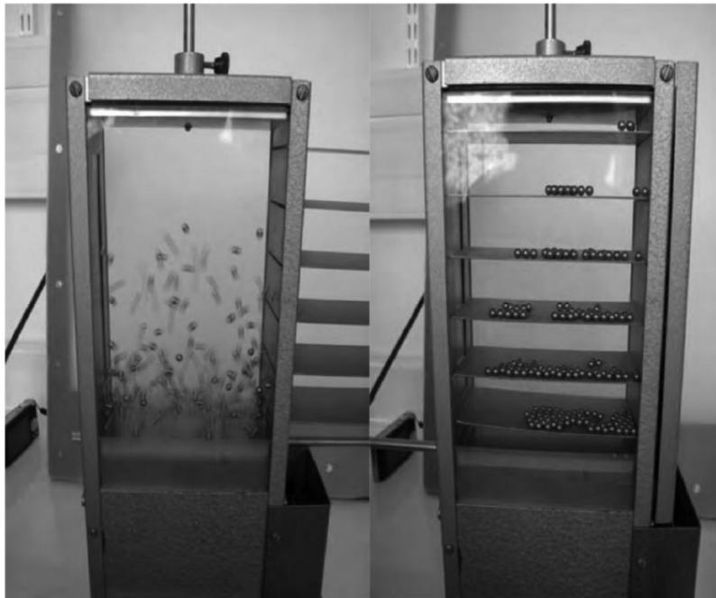
FIGURE 3 – (en haut) Facteur de Boltzmann illustré sur l'exemple de la compétition entre l'énergie potentielle de pesanteur et l'énergie d'agitation thermique. (en bas) Vérification de la loi de Boltzmann avec des billes d'acier en agitation interceptées par des paliers.
