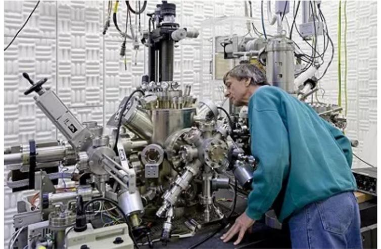
Ce type de microscope est appelé "microscope à effet tunnel" (STM pour "scanning tunnel microscope") car des électrons peuvent passer par effet tunnel entre un substrat conducteur et une pointe métallique sous l'effet d'une différence de potentiel. Le potentiel étant élevé dans le vide, et plus bas dans les conducteurs, l'électron traverse donc une barrière de potentiel.
