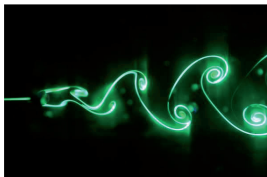
Visualisation d'allées de Von Karman dans un fluide par vélocimétrie laser
