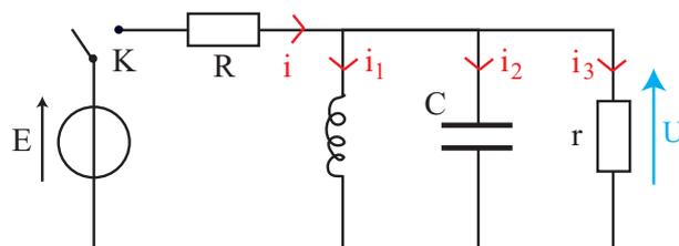
1. Déterminer  $U$ ,  $i_1$ ,  $i_2$ ,  $i_3$  juste après la fermeture de l'interrupteur et au bout d'un temps très grand. On présentera les résultats sous forme d'un tableau.
