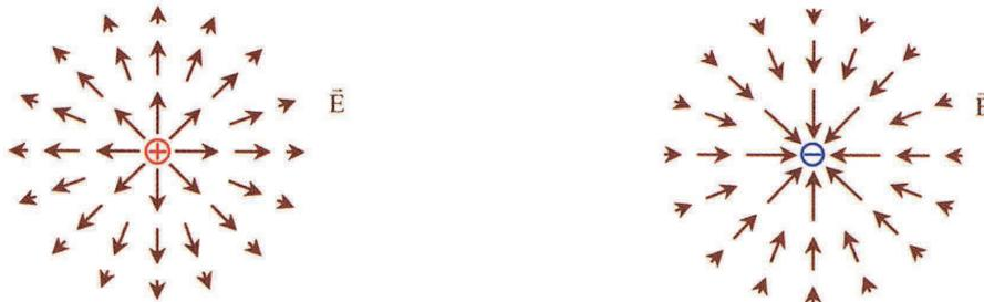
Champs électrostatiques d'une charge ponctuelle positive (à gauche) et négative (à droite).
