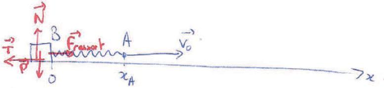
1) Mise en mouvement lorsqu'il y a glissement, lorsque  $\|\vec{T}\| = f\|\vec{N}\|$ .
