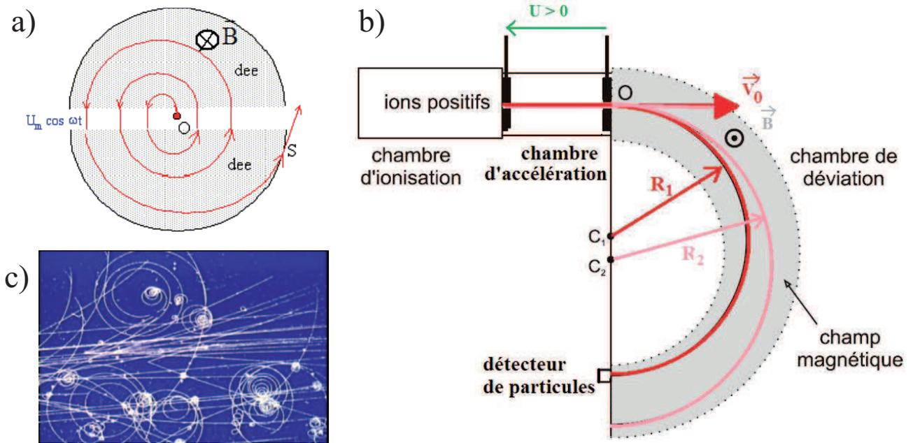
FIGURE 1 – a) Cyclotron, b) Spectromètre de masse, c) Chambres à bulle ou à brouillard.
