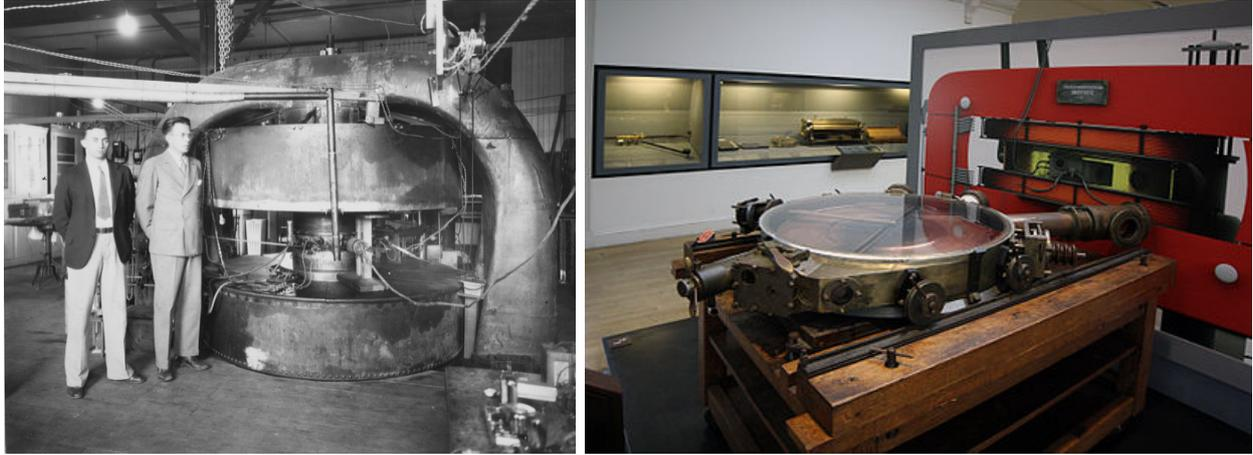
FIGURE 3 – a) Lawrence et Livingston devant l'un des premiers cyclotrons (69cm de diamètre ici). b) Chambre à vide sortie de l'aimant du premier cyclotron français installé au Collège de France en 1937 par Frédéric Joliot-Curie. On devine les Dés à travers la vitre.
