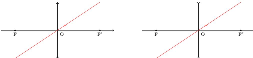
Un rayon lumineux incident parallèle à l'axe optique émerge en passant par le foyer image.
