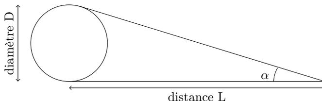
Dans l'approximation à l'infini, une fois connu le diamètre apparent, calculer la taille de l'image est particulièrement simple :  $A'B' = f'\alpha$ .
