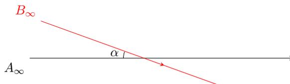
Pour calculer cet angle, il faut bien entendu revenir à la distance entre l'objet et la lentille, ainsi qu'à la taille de l'objet exprimée par une longueur. Par exemple, la lune est à une distance  $L = 380000km$  de la terre en moyenne et son diamètre est  $D = 3500km$ , son diamètre apparent (vu depuis la terre) est donné par  $\alpha = \frac{D}{L}$  ce qui fait environ 0,009 radians, soit 0,5 degrés.
