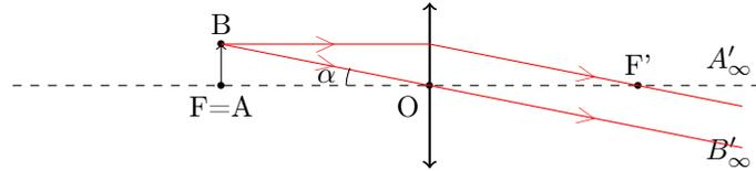
La taille de l'image est là encore caractérisée par un angle, égal à la taille de l'objet divisée par la focale de la lentille (on se place toujours dans l'approximation des petits angles) :
