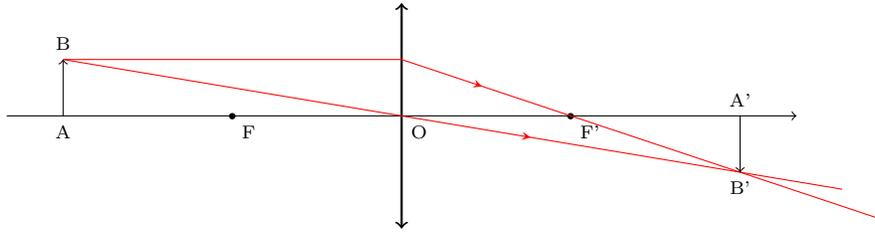
Le montage 4f est une situation importante car il correspond, à  $f'$  fixé, à la plus petite distance entre l'objet et l'image. On le retrouve dans de nombreuses situations et il est important de savoir l'identifier.
