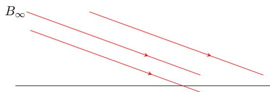
L'image d'un objet à l'infini est dans le plan focal image. Cela se retrouve à la fois dans la construction, puisque les rayons incidents sont parallèles entre eux (et donc ils convergent dans le plan focal image) et dans la relation de conjugaison :
