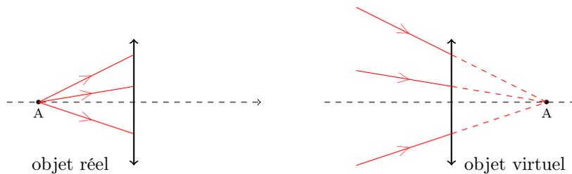
Pour tracer l'image correspondant à un objet virtuel, il suffit de choisir deux rayons lumineux qui se dirigent vers ce point et de tracer les rayons émergents correspondants. Avec un objet virtuel, il est possible d'obtenir une image réelle avec une lentille divergente.
