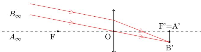
En fait, l'infini en optique est souvent à quelques mètres... Si on regarde un objet à un mètre avec l'oeil, qui a une focale de l'ordre de 2cm et que l'on fait l'approximation d'un objet à l'infini, on obtient la position de l'image à 2cm du cristallin au lieu de 2,04 cm, soit une erreur relative de 2% seulement...
