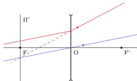
On peut bien sûr considérer plusieurs variantes à la méthode ci-dessus : on peut prendre un rayon auxiliaire parallèle au rayon incident, mais qui passe par le foyer objet. On peut aussi prendre un rayon auxiliaire qui coupe le rayon incident dans le plan focal objet, soit passant par le centre soit parallèle à l'axe optique : ils émergent parallèles entre eux.
