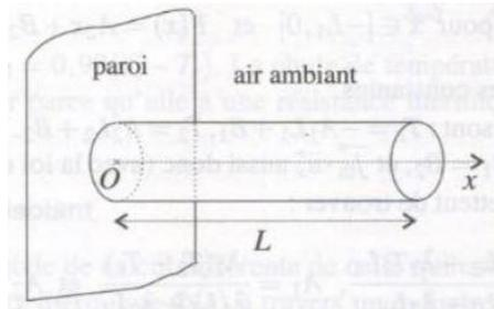
1. En appliquant le premier principe à la portion d'ailette comprise entre  $x$  et  $x + dx$  montrer que la température  $T$  de l'ailette vérifie l'équation suivante :
