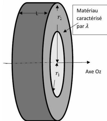
On considère un cylindre conducteur thermique creux de longueur  $L$ , occupant l'espace  $r_1 < r < r_2$  constitué d'un matériau de conductivité  $\lambda$  dans lequel il n'y a aucune source thermique dans le matériau.
