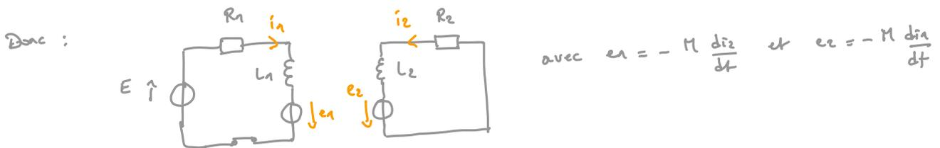
3. (1) :  $E = -e_1 + L \frac{di_1}{dt} + R_1 i_1$ , soit  $E = M \frac{di_2}{dt} + L \frac{di_1}{dt} + R_1 i_1$
