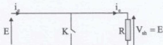
En HF, les bobines ne laissent pas passer le courant, on a donc un courant nul dans la résistance R et  $V_{sb}=0$ .
