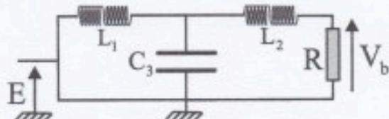
2. En BF, les bobines équivalent à des interrupteurs fermés et on a directement  $V_{sb} = E$  avec la loi des mailles.
