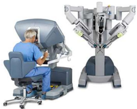
Le robot esclave étudié est constitué de trois axes permettant de déplacer l'instrument chirurgicale positionner sur la plaque support en translation selon les trois directions de l'espace X, Y et Z. On s'intéressera à l'axe de l'élévation du dispositif de commande de l'instrument chirurgicale décrit par le schéma bloc suivant 2.
