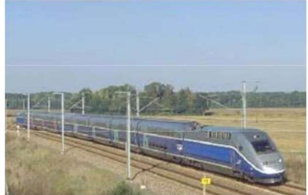
La rame de TGV est composée de deux motrices et de huit voitures. La liaison avec les rails est assurée par 13 bogies. Quatre d'entre eux, implantés sous les motrices, sont moteurs, les neuf autres, qualifiés de porteurs, sont positionnés entre deux voitures.
