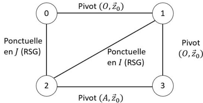
**Q5.** Identifier le type de train puis déterminer le rapport de réduction  $\frac{\omega_{30}}{\omega_{10}}$
