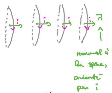
On utilise  $\begin{cases} e = - \frac{d\phi}{dt} : \text{loi de Faraday} \Rightarrow \text{cohérence entre } \mathcal{E} \text{ et } \vec{n} \\ \phi = L i : \text{def de l'auto-inductance } L \Rightarrow \text{cohérence entre } \vec{n} \text{ et } i \end{cases}$
