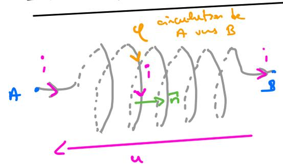
on modélise usuellement l'enroulement  $\Leftrightarrow$  hélicoidal par un ensemble de spires planes
