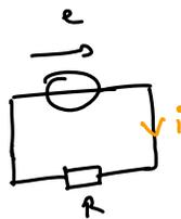
!  $e$  est orienté dans le même sens que  $C$  → si  $C$  et  $i$  dans le m même sens,  $e$  et  $i$  aussi.
