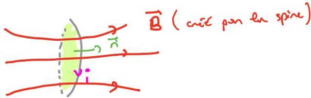
$$\phi = \text{flux de } \vec{B} \text{ au travers de la spire (flux propre)}$$
