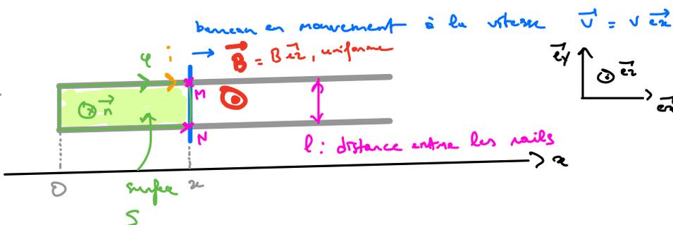
On considère les rails de Laplace et un plan horizontal. Le barreau glisse sans frottement sur les rails (en fait il roule -)
