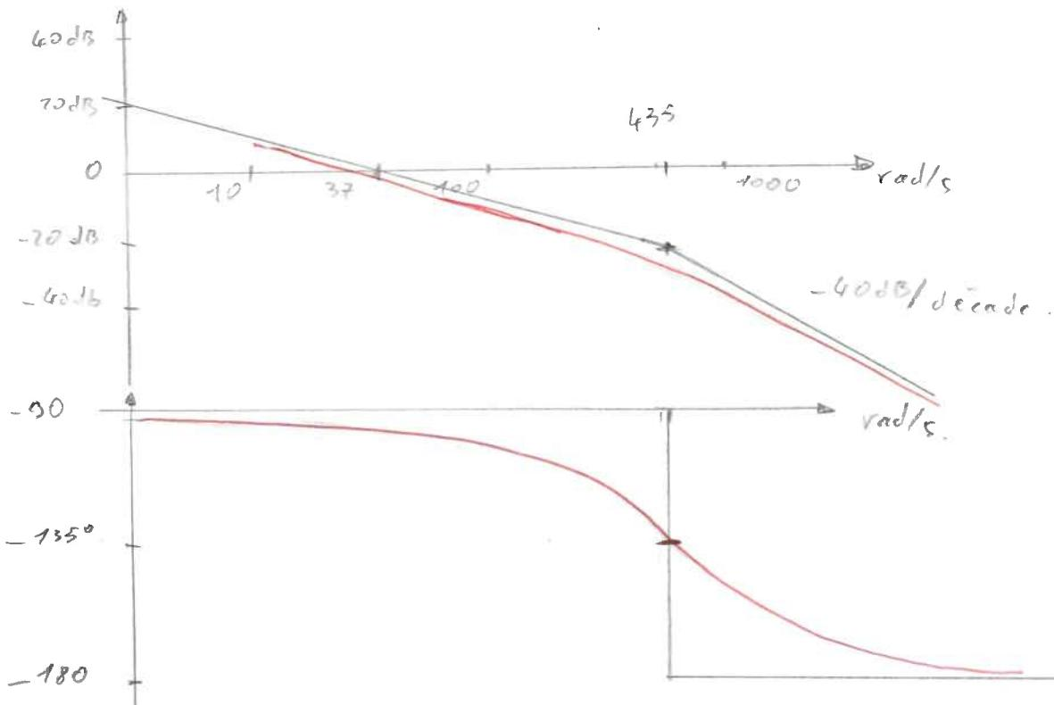
On veut  $M\varphi \geq 45^\circ$ , il faut donc remonter la courbe de gain afin qu'elle coupe l'axe à 435 rad/s (pulsation ayant une phase de  $-135^\circ$ ). On cherche  $k$
