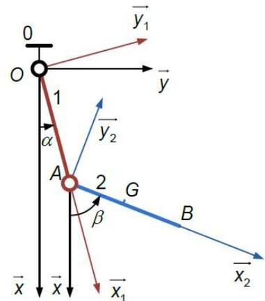
La tige **1**, d'extrémités  $O$  et  $A$  est en liaison pivot d'axe  $(O, \vec{z})$  avec le bâti **0**. On note  $R_1 = (O, \vec{x}_1, \vec{y}_1, \vec{z})$  un repère lié à **1**, tel que  $\vec{OA} = 2a\vec{x}_1$  et on pose  $\alpha = (\vec{x}, \vec{x}_1)$ .
