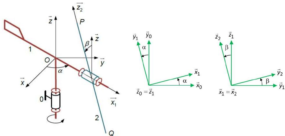
Soit  $R_0 = (O, \vec{x}, \vec{y}, \vec{z}) = (O, \vec{x}_0, \vec{y}_0, \vec{z}_0)$  un repère lié au mât fixe **0** de l'éolienne. La girouette **1** est en liaison pivot d'axe  $(O, \vec{z})$  avec le mât **0**. Le repère  $R_1 = (O, \vec{x}_1, \vec{y}_1, \vec{z})$  est lié à la girouette, on a  $\vec{z} = \vec{z}_1$  et on pose  $\alpha = (\vec{x}, \vec{x}_1)$ .
