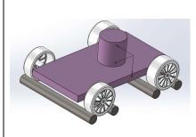
Il est nécessaire de dimensionner les rouleaux afin qu'ils s'approchent en fonctionnement de l'inertie d'un véhicule, autrement dit, l'inertie équivalente des rouleaux doit être proche de l'inertie équivalente de la voiture.
