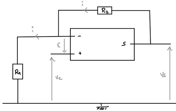
En fonctionnement linéaire et avec un gain considéré comme infini,  $\epsilon = 0$ , donc  $V_- = V_e$ . Les courants d'entrées sont quasiment nuls, donc le même courant  $i$  circule dans les résistances  $R_1$  et  $R_2$ . On a donc  $V_e = R_1 i$  et  $V_s = (R_1 + R_2) i$  et donc :
