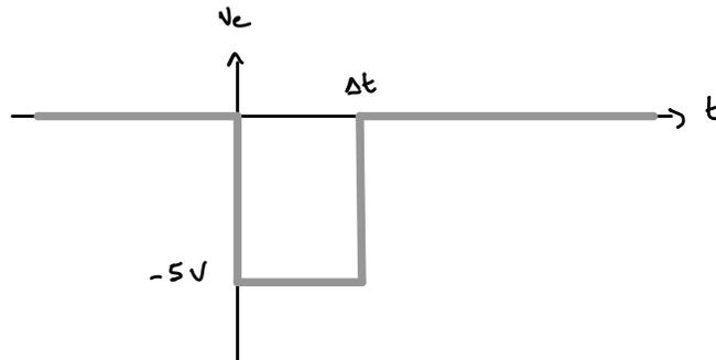
**11.** Il faut comparer  $\Delta t$  avec la constante de temps  $\tau = RC$  du circuit, ce qui donne numériquement  $\Delta t \ll 6,5 ms$ . La tension  $u_C$  n'a pas le temps de varier.
