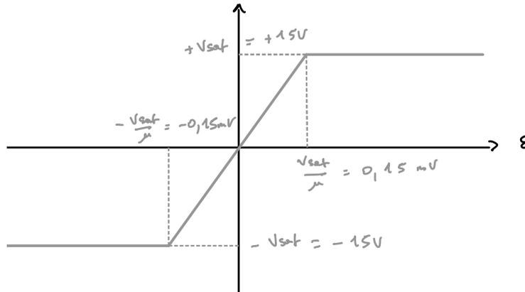
2. La rétroaction sur l'entrée inverseuse permet le fonctionnement linéaire de l'ALI. Le gain intrinsèque étant considéré comme infini, la tension différentielle d'entrée est approximativement nulle, soit  $V_+ = V_-$ . Comme  $V_s = V_-$ , on a finalement :
