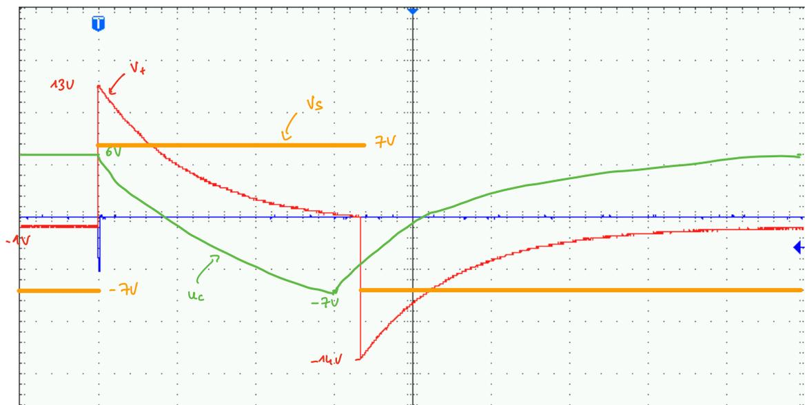
17. Il faut  $T \gg \tau$  pour que le circuit ait le temps de revenir à l'équilibre avant une nouvelle impulsion (on peut aussi dire  $T > 2t_1$ ).
