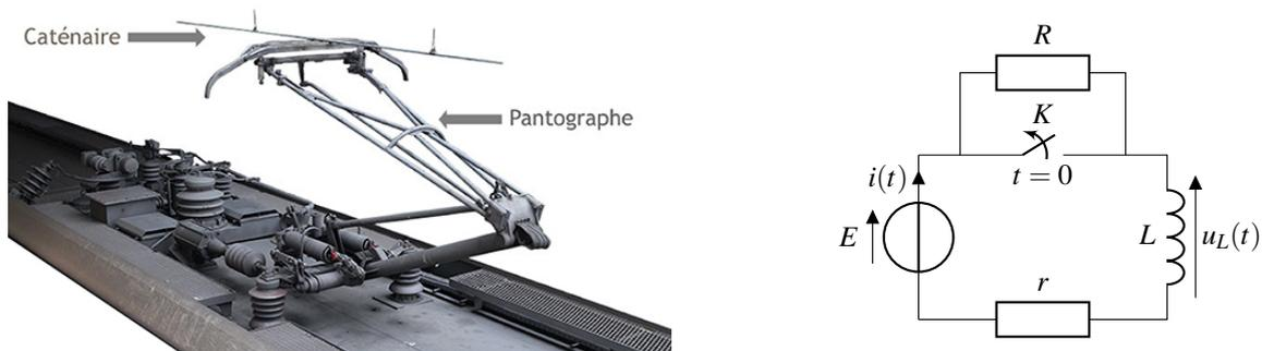
Figure 2: Principe de fonctionnement du caténaire et du pantographe, et schéma électrique du modèle.
