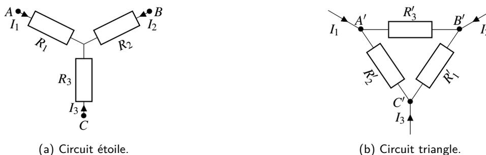
Figure 1: Schémas des circuits électriques
