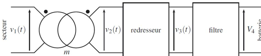
Un transformateur correspond à une carcasse ferromagnétique et de deux enroulement, comme illustré ci-dessous. On considère que les deux f.c.é.m induites,  $v_1(t)$  et  $v_2(t)$ , sont dues à la présence d'un même champ magnétique variable  $B(t)$  passant par les  $N_1$  spires de section  $S$  du premier enroulement de droite, et par les  $N_2$  spires de section  $S$  du deuxième enroulement de gauche.
