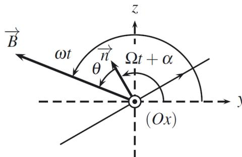
Ce dispositif est utilisé en moteur électrique : le champ magnétique entraîne la bobine.
