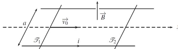
La résistance électrique des rails est négligeable, les résistances électriques de chacune des deux tiges sont égales à  $R/2$ . L'inductance propre du circuit formé par les rails et les tiges est négligée.
