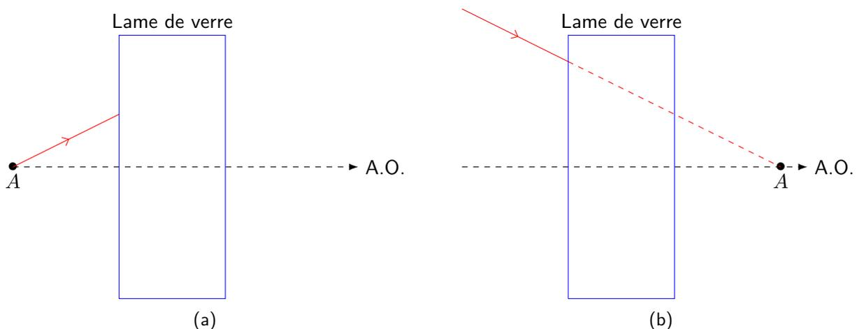
Figure 1.18 – Schéma optiques d'objets ponctuels (a) réel et (b) virtuel.
