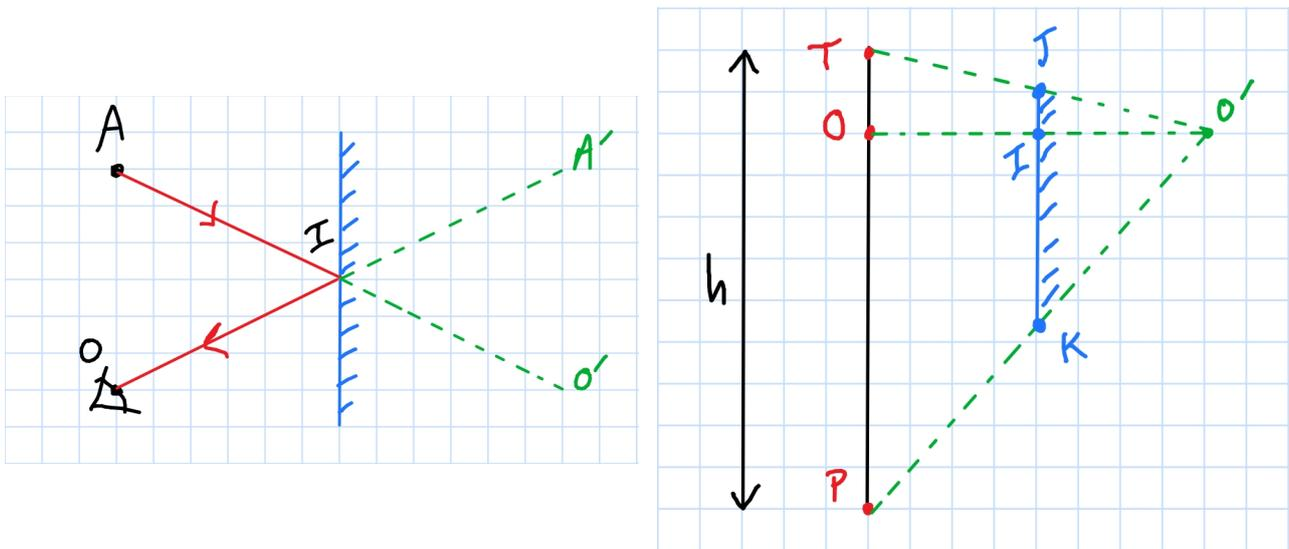
(a) Schéma optique d'un miroir (h) schéma de positionnement d'un miroir.
