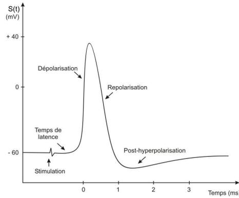
(b) Évolution du potentiel d'action  $S = V_{int} - V_{ext}$  en fonction du temps lors de la stimulation d'un neurone. La stimulation provoque l'ouverture de canaux à sodium : les parois deviennent fortement perméables au sodium pendant un court instant, ce qui entraîne la polarisation. La diffusion des ions potassium et les pompes sodium-potassium permettent un retour au potentiel d'équilibre (repolarisation).
