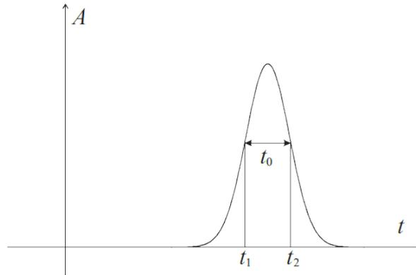
Figure 4: Impulsion lumineuse.
