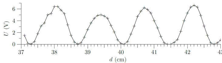
Figure 6: Tension  $U$  en fonction de la distance  $x = d$  entre l'antenne et l'émetteur.
