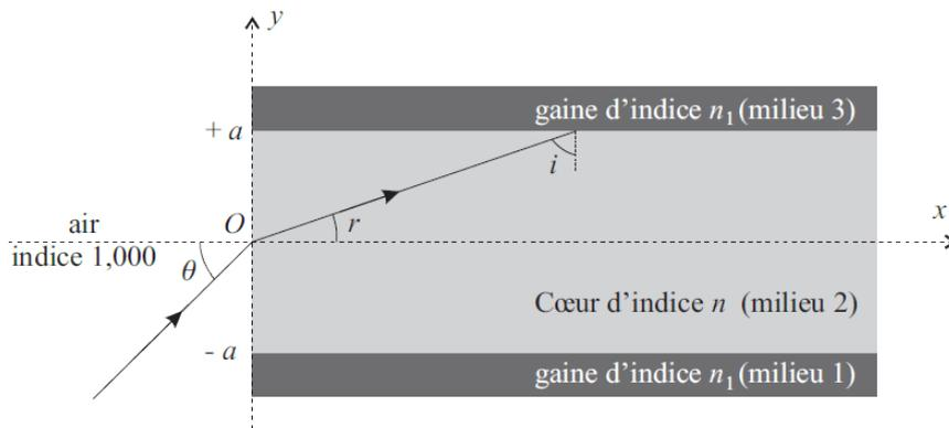
Figure 3: Fibre optique en coupe.
