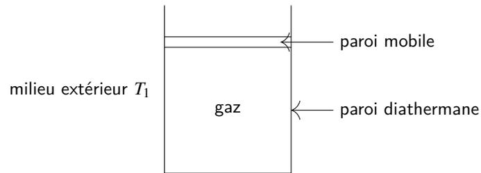
On débloque la paroi et on la déplace de manière quasi-statique jusqu'à une position, telle que le volume  $V_f'$  offert au gaz soit  $V_f' = 2V_1$ , et on la bloque à nouveau.
