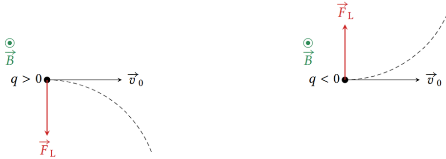
FIGURE 1 – Sens de la force de Lorentz magnétique en fonction du signe de q
